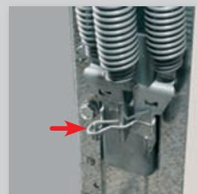
Les ressorts sont réglés en usine. Sur chantier, un ajustement est possible grâce à un simple déplacement de l'accroche-ressort dans l'huissierie.
